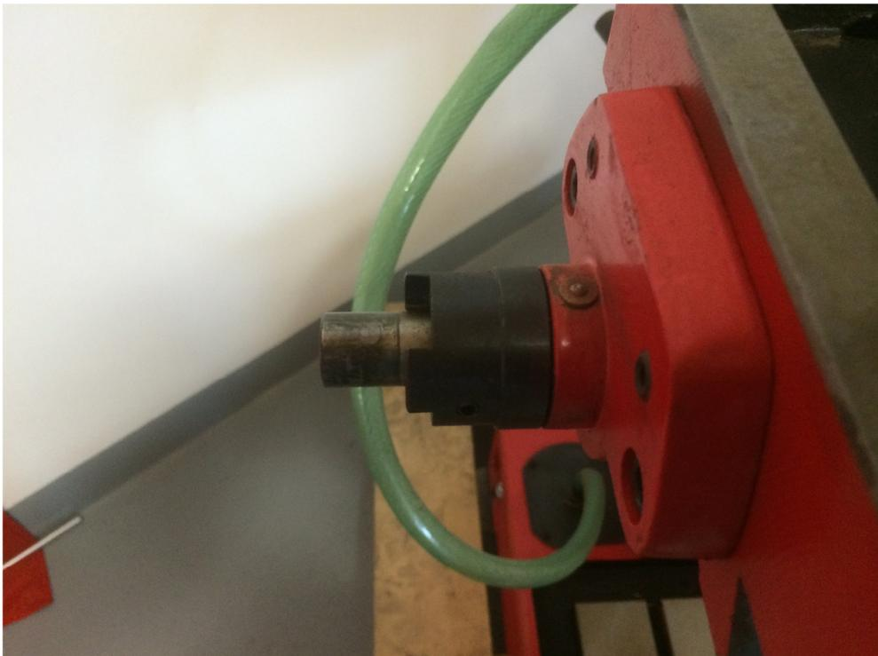
Dann setzen Sie den AVX-Vorschub auf die vorhandene Spindel auf und fixieren diesen mit der Madenschraube auf der Welle. Als nächsten Schritt wird der Vorschub an den vorhandenen Bohrungen an der Maschine befestigt und kann nun benutzt werden.
