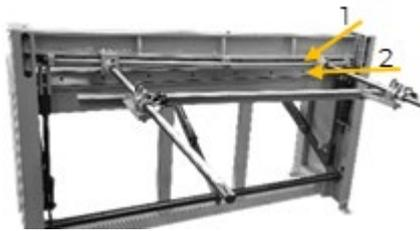
Für besseren Zugang zu den Schneidmessern entfernen Sie die Führungsschienen des Hinteranschlages.
