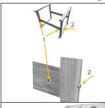
**1.** Legen Sie den Quermutterbolzen des Schraubens in die Öffnung der Rahmenstrebe (1).
